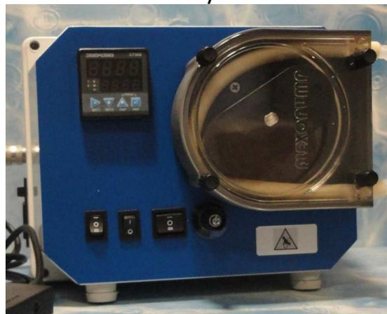
**FUNZIONI STANDARD:** comando marcia/arresto con interruttore frontale - comando direzione di rotazione- regolazione di velocità tramite potenziometro
